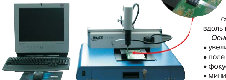
Рис. 3. Система оптического контроля LS 3000
